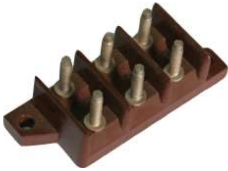
НЕУ6 672 023 Плата шестиконтактная Параметры: 70×6; 2 отверстия для крепления Ø4,5 Шпилька 6шт., размер Ø7, l=23 Материал: фенопласт Э2 К-21-22
