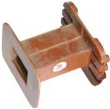
ЭП7 804 299 Каркас Параметры: внешние размеры окна 16 \times 12 Материал: ДСВ-2Р-2М
