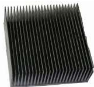
РОО Радиатор пластинчатый односторонний Параметры: 125×122×46 с шагом 5; 10 Материал: АК-12
