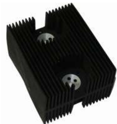
ЭП7 317 156 Радиатор пластинчатый двусторонний Параметры: 120×70×82 с шагом 5; 10 Материал: АК-12
