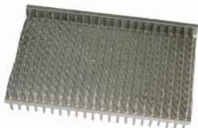
КС8 650 457 Радиатор игольчатый двусторонний, односторонний Параметры: 155×100×35 с шагом 7 Материал: АК-12 Примечание: возможно изготовление одностороннего с размерами 155×100×70
