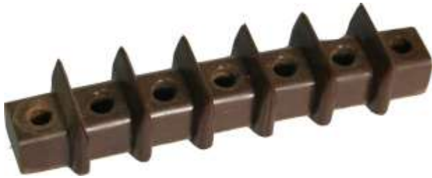
НЕС7 814 005 Плата Параметры l=75, 2 отверстия для крепления Ø7 5 отверстий Ø7 Материал: фенопласт Э25-014-17
