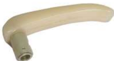
ОЦ4 400 052 Ручка (опрессованная) Параметры: L=130; входное отверстие \varnothing 10 Материал: ПА610-1-108,22
